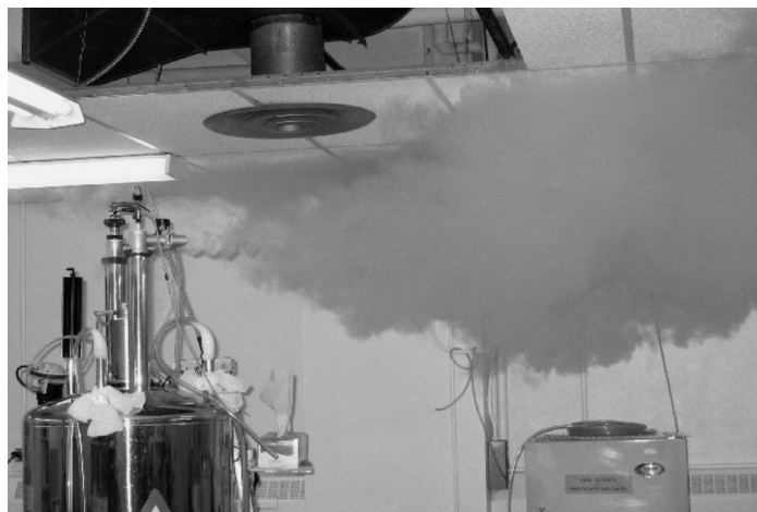
FIGURE 2 – Fuite d'hélium suite à la destruction ( quench ) d'un aimant supraconducteur utilisé pour la RMN. Département de Chimie de l'université de l'Alberta
