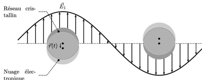
**Figure 4** Représentation schématique des oscillations de plasmon pour une nanoparticule sphérique, montrant le déplacement des électrons libres par rapport au réseau cristallin des noyaux métalliques
