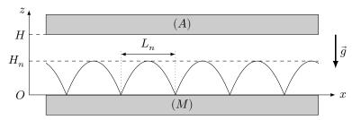
Figure 7 Rebonds d'un neutron dans un guide
